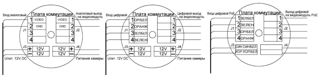
Рисунок 4.3 – Схема подключения термокожуха
