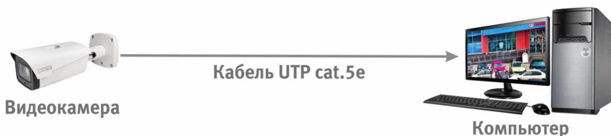
Рисунок 6.3 – Схема подключения видеокамеры к компьютеру
