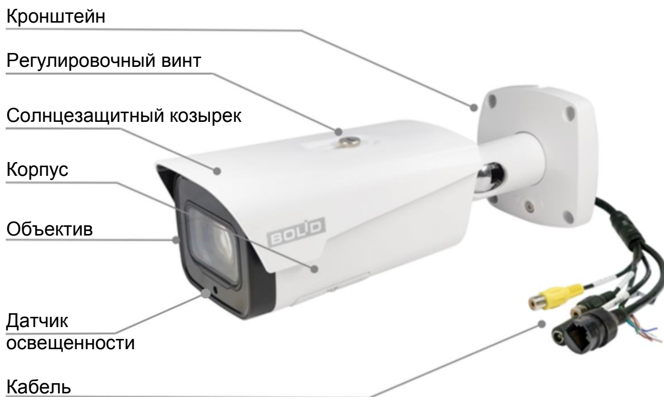
Рисунок 4.1 – Внешний вид и основные элементы видеокамеры
