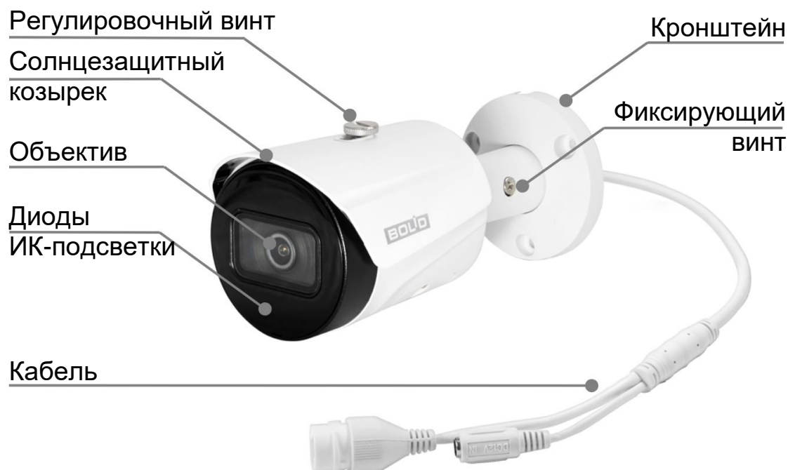
Рисунок 4.1 – Внешний вид и основные элементы видеокамеры
