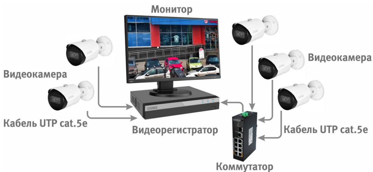
Рисунок 6.4 – Схема подключения видеокamеры к видеорегистратору
