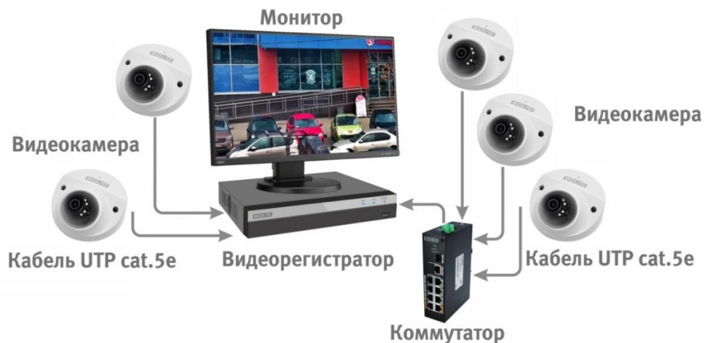
Рисунок 6.4 – Схема подключения видеокamеры к видеорегистратору
