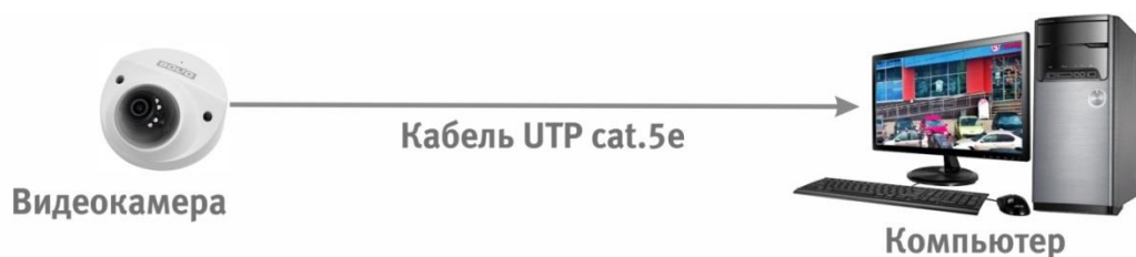
Рисунок 6.2 – Схема подключения видеокамеры к компьютеру
