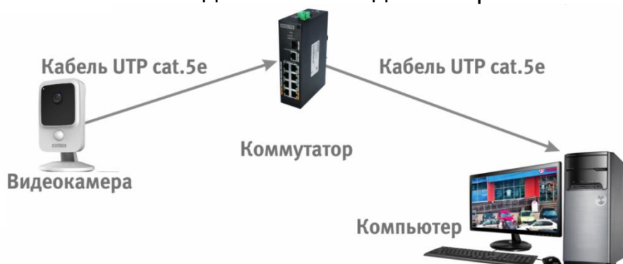
Рисунок 6.3 – Схема подключения видеокamеры к компьютеру через коммутатор
