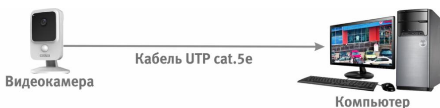
Рисунок 6.2 – Схема подключения видеокamеры к компьютеру
