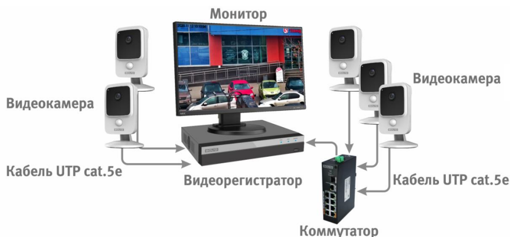
Рисунок 6.4 – Схема подключения видеокamеры к видеорегистратору
