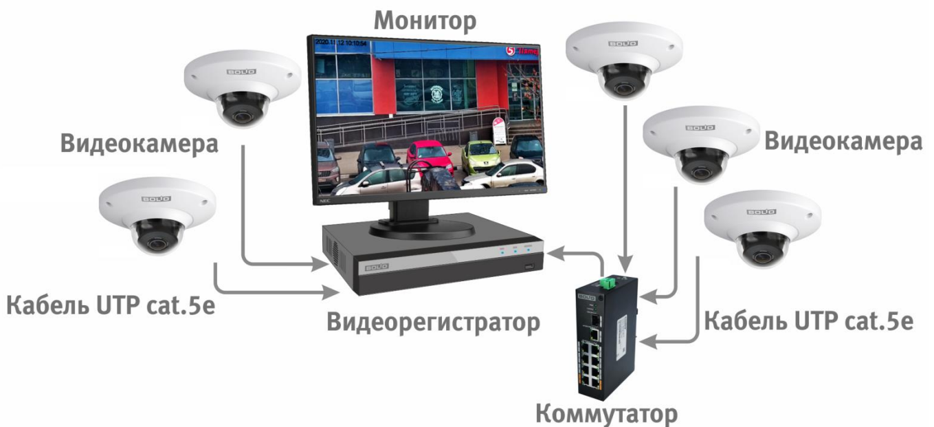
Рисунок 6.4 – Схема подключения видеокamеры к видеорегистратору
