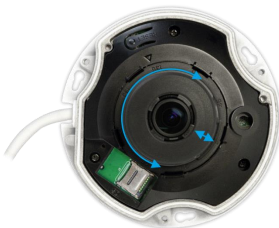
Рисунок 5.4 – Настройка направления объектива
