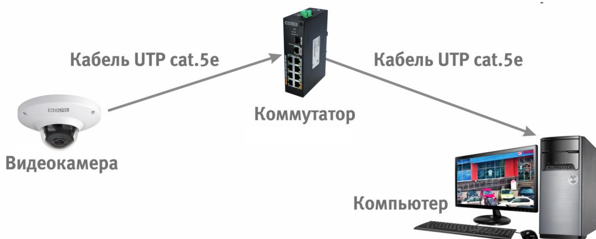
Рисунок 6.3 – Схема подключения видеокамеры к компьютеру через коммутатор
