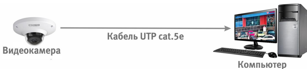
Рисунок 6.2 – Схема подключения видеокамеры к компьютеру
