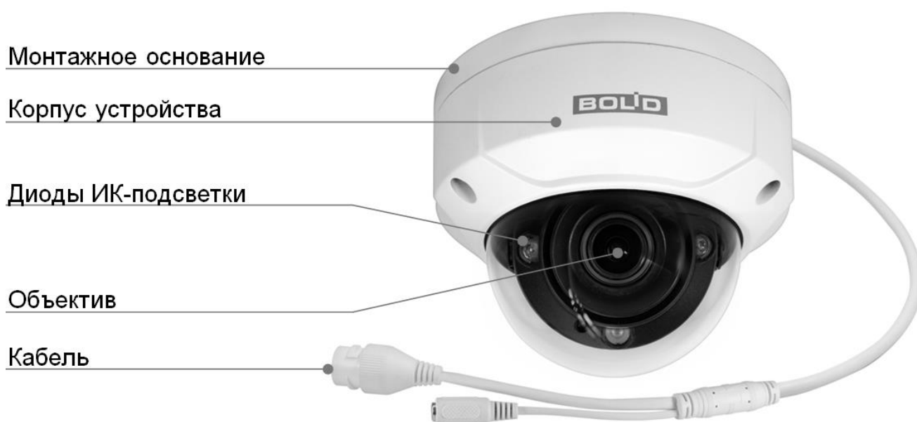
Рисунок 4.1 – Внешний вид и основные элементы видеокамеры
