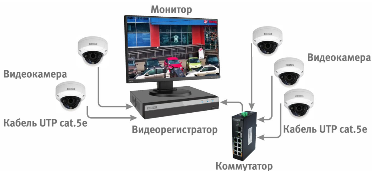
Рисунок 6.5 – Схема подключения видеокamеры к видеорегистратору
