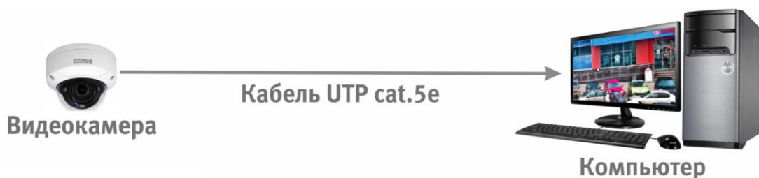
Рисунок 6.3 – Схема подключения видеокamеры к компьютеру
