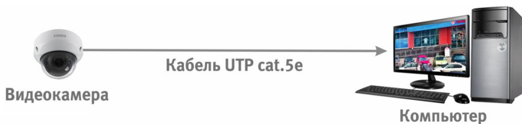
Рисунок 6.2 – Схема подключения видеокамеры к компьютеру
