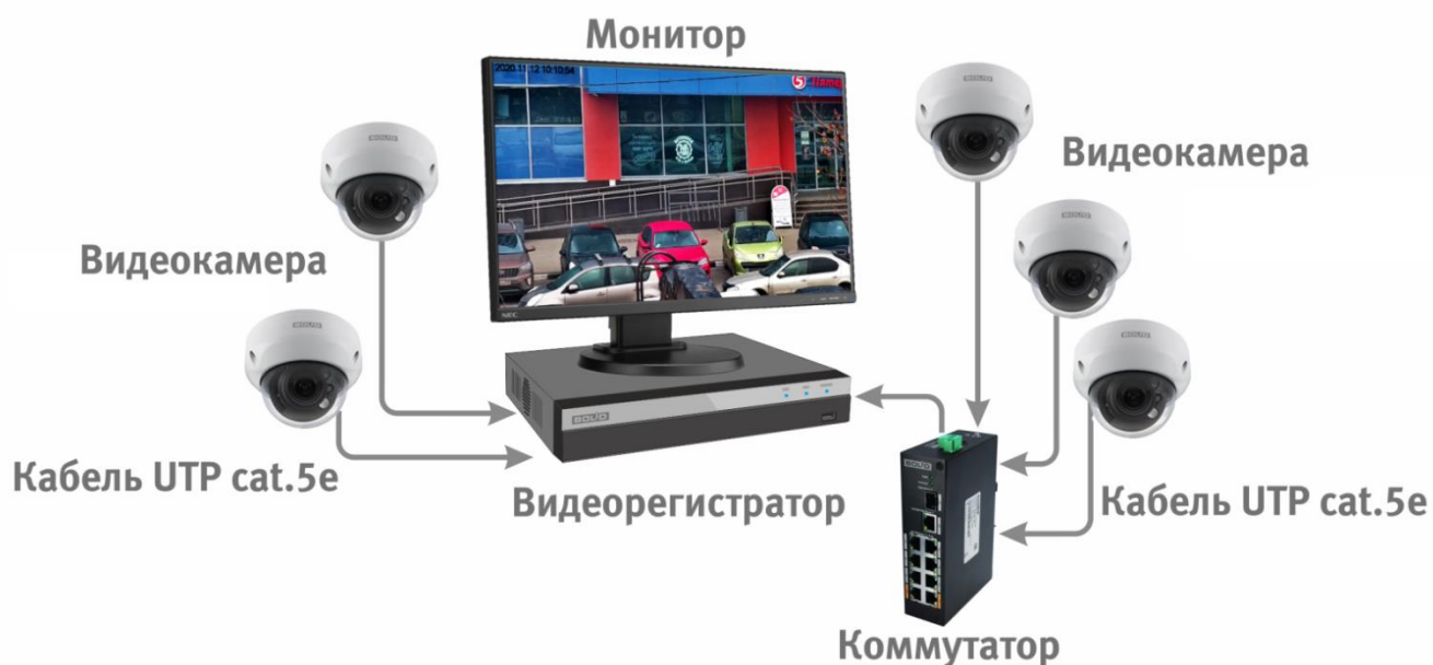
Рисунок 6.4 – Схема подключения видеокamеры к видеорегистратору
