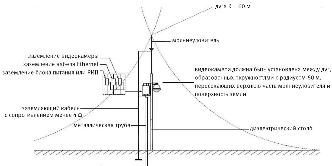
Рисунок 6.12 – Установка молниеотвода
