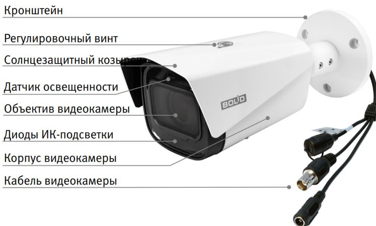
Рисунок 4.1 – Внешний вид и основные элементы видеокамеры
