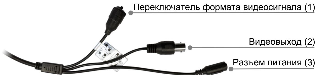
Рисунок 6.1 – Концевая раскладка кабеля видеокамеры
