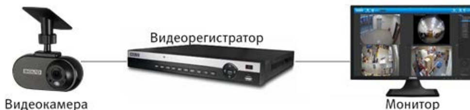
Рисунок 5.2 – Схема подключения видеокамеры
