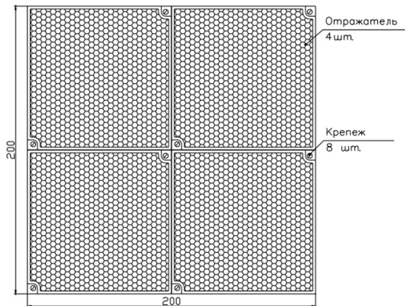
Рисунок 2 - Монтажный чертеж четырех отражателей
