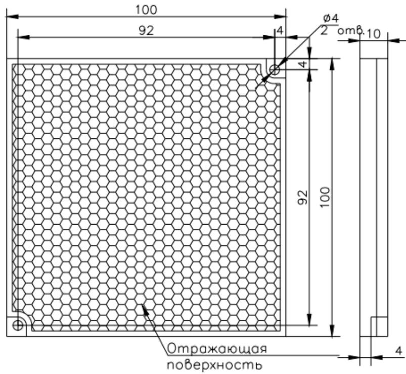
Рисунок 1 - Общий вид отражателя
