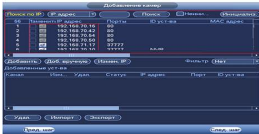
Рисунок 11 Настройка добавления камер по поиску в сети
